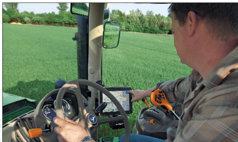
Les terminaux Isobus à grand écran tactile, offrent un niveau d'ergonomie suffisant pour un affichage simultané des réglages du tracteur et de l'outil.
