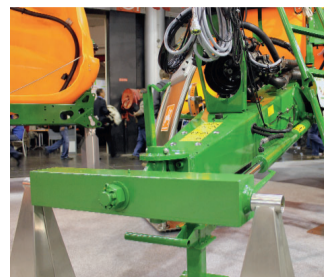
Le conducteur a la possibilité de piloter manuellement l'essieu.
