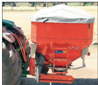
L'entraînement électrique permet de s'affranchir du régime moteur du tracteur.
