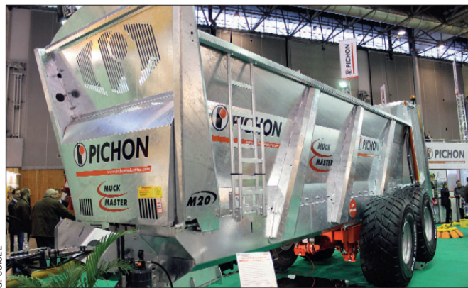
Les épandeurs Muck Master sont entièrement galvanisés.
