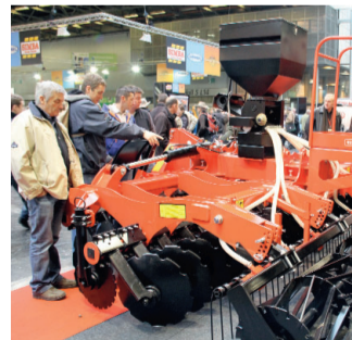
Le Diskator dispose de disques crénelés montés sur sécurité élastomère.
