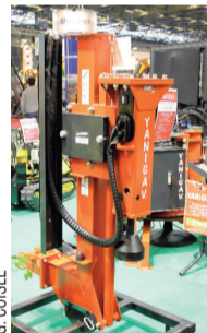
L'enfonce pieux est adaptable sur pelle et mini-pelle
