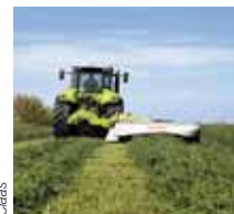
La faucheuse Disco 2700 Contour peut désormais recevoir un conditionneur à rouleaux.
