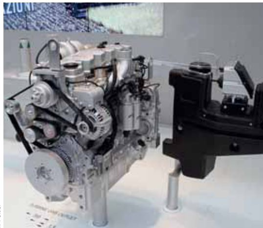
Un dispositif de réduction catalytique sélective se traduit par l'adoption d'un réservoir supplémentaire d'AdBlue et d'un réacteur catalytique à l'échappement.
